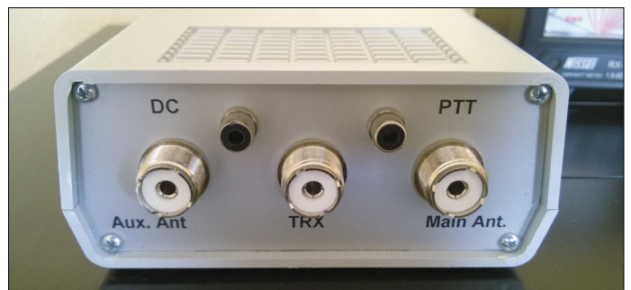
Bild 2: Antennenbuchsen auf der Rückseite für Hilfsantenne, Transceiver, Stationsantenne; oberhalb liegen Cinch-Buchsen für 12 V und PTT.
