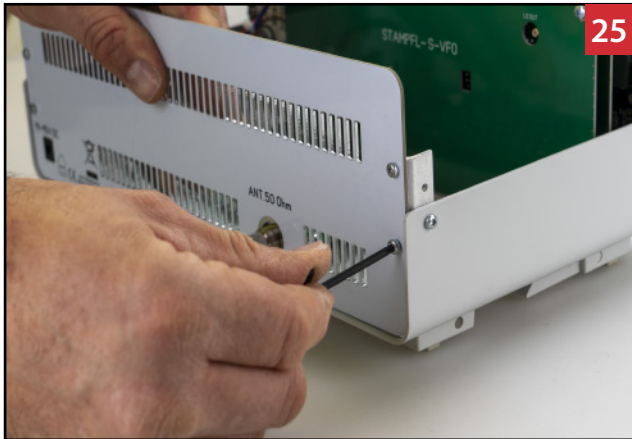
Gehäuserückseite mit 4x Linsenkopfschraube Torx M3 x 10 mm festschrauben.
