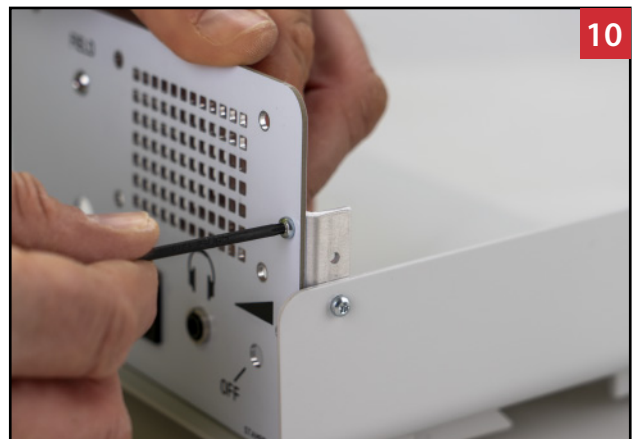
1x Gehäusefrontplatte mit 2x Linsenkopfschraube Torx M3 x 10 mm mit der Gehäuseunterschale montieren.
