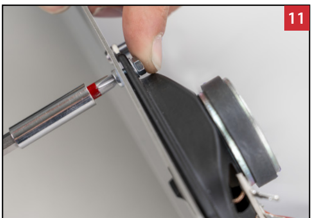
Lautsprecher mit 4x Linsenkopfschraube Kreuzschlitz M4 x 10 mm, 4x Unterlegscheibe M4 und 4x Sechskantmutter M4 an die Frontplatte montieren. Die Lötungen zeigen nach aussen. Vor dem Festziehen den Lautsprecher soweit es geht an den Alu-Winkel schieben.
