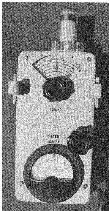
foto 6 - La testa esploratrice "tuning head" con bobina inserita.
