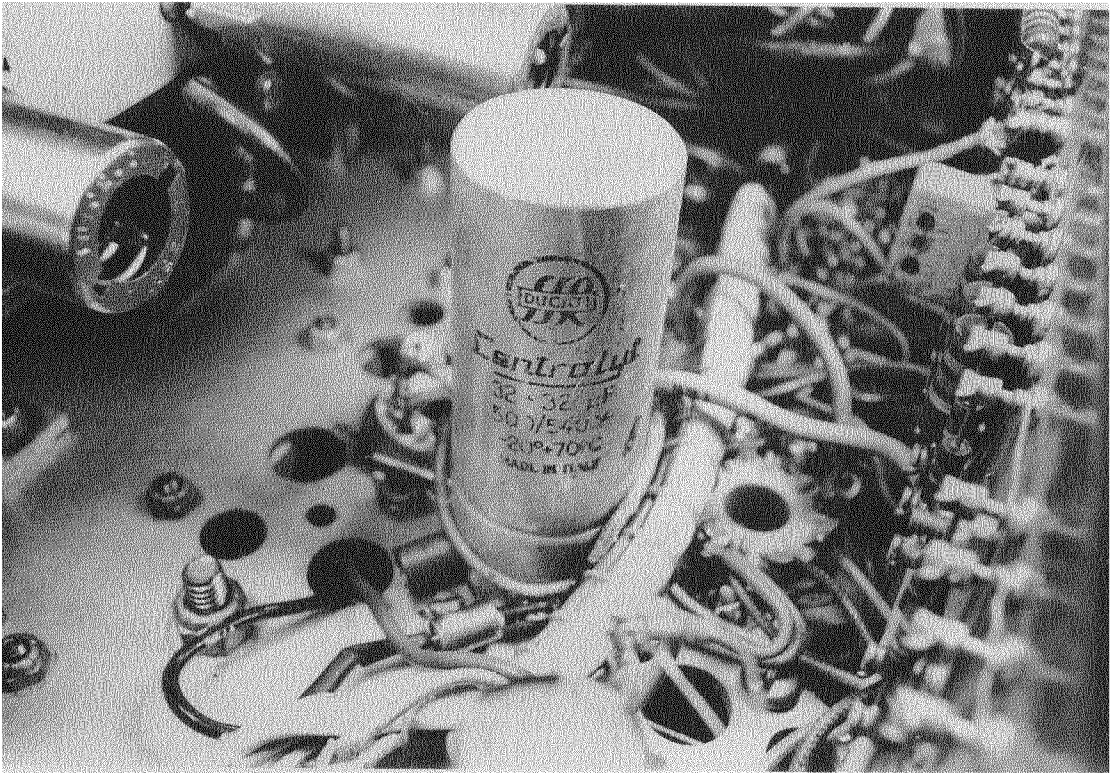
figura 7 - Il condensatore da 32+32 \mu F 500V, (alla sua base si intravede il diodo da 3A dentro un'aletta di raffreddamento).
