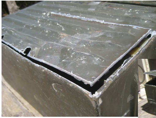
Ouverture du coffret à la disqueuse et extraction du châssis.
