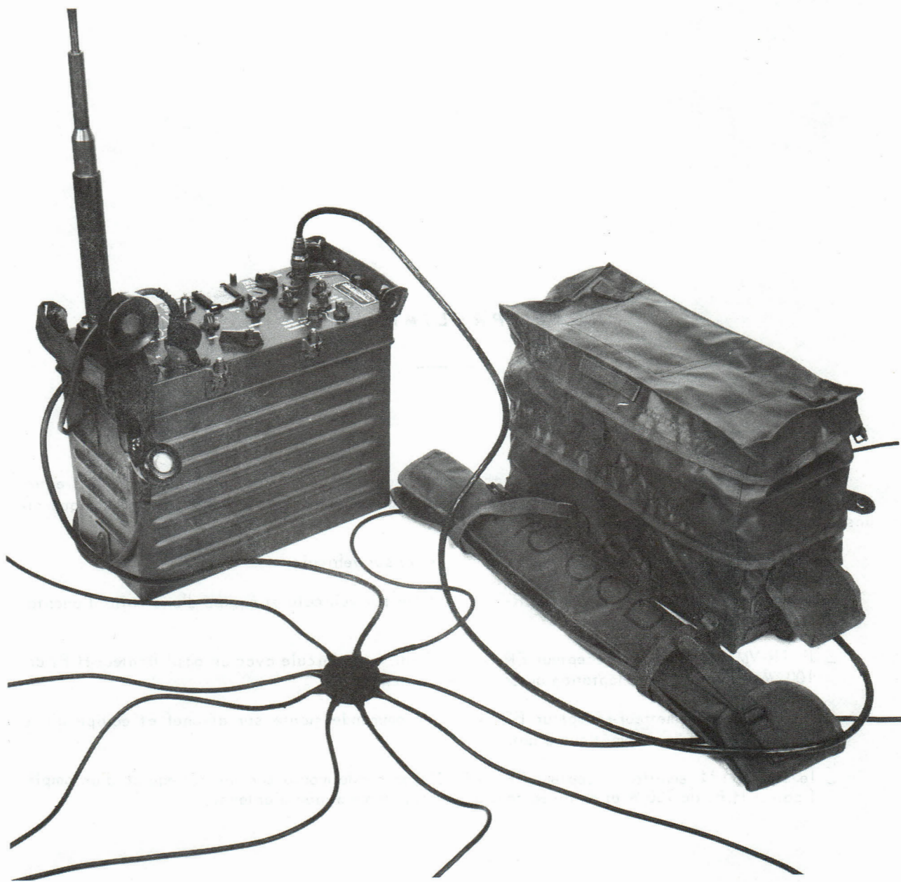
POSTE RADIO TR - TM - 4 - B ( Vue d'ensemble )
