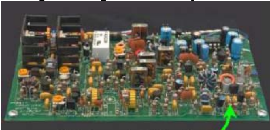
Mida la frecuencia del OFV aquí (rabillo superior de R-27)
